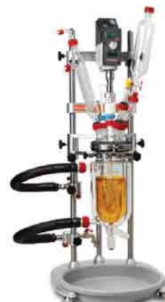
Для присоединения стеклянных аксессуаров применяются запатентованные лабораторные шлифы Rodaviss, которые не требуют смазки и позволяют быстро и без риска сколов извлечь даже «залипший» шлиф большого диаметра.
