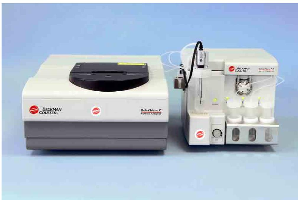
Компания Миллаб предлагает современную серию анализаторов DelsaNano для определения размера и дзета-потенциала наночастиц., в которых используется методы фотонно-корреляционной спектроскопии и электрофоретического светорассеяния.
